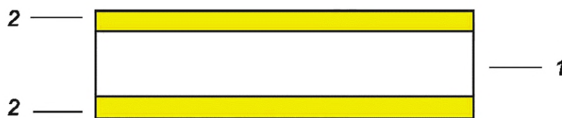
1 — вспененный полиэтилен (EPE); 2 — полиэтилен низкой плотности (LDPE) или полиэтилен высокой плотности (HDPE)
