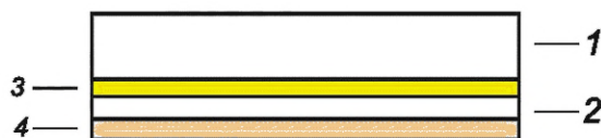
1 — вспененный полиэтилен (EPE); 2 — вкладыш из оловянной фольги (Tin); 3 — полиэтилен низкой плотности (LDPE); 4 — поливинилиденхлорид (PVDC)
