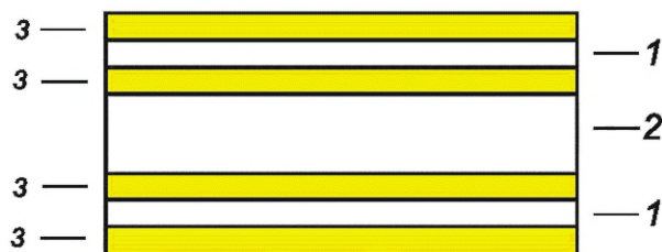
1 — поливинилиденхлорид (PVDC); 2 — вспененный полиэтилен (EPE); 3 — полиэтилен низкой плотности (LDPE)
