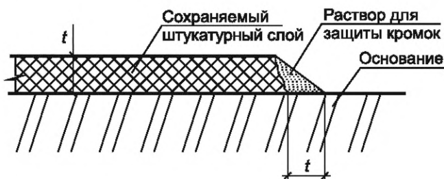
Рисунок 1 — Защита кромок сохраняемой штукатурной отделки (в разрезе)
