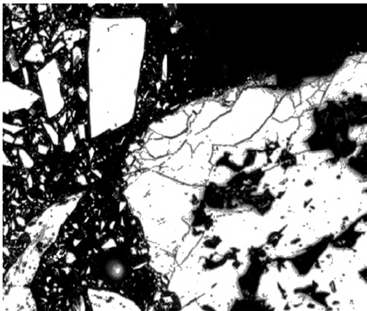
Рисунок А.13 — Дезинтеграция зерна угля с пустотами и многочисленными трещинами
