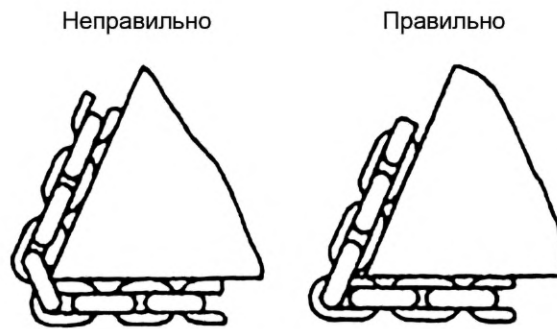
Рисунок 5 — Строповка грузов цепными стропами
