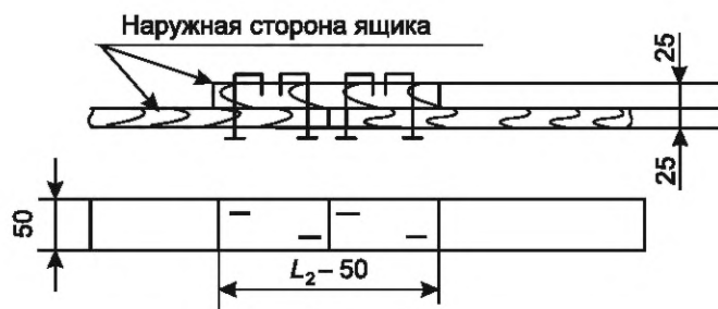
Стыковка продольных планок при длине ящика более 3000
