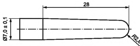
Рисунок 7 — Шаблон диаметром 7 мм для испытаний сетки
