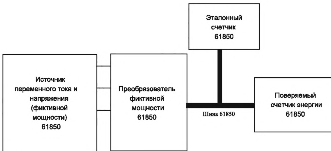
Рисунок В.2 — Схема испытательной цепи с применением источника и преобразователя фиктивной мощности, эталонного ЦСч для поверки однофазного ЦСч
