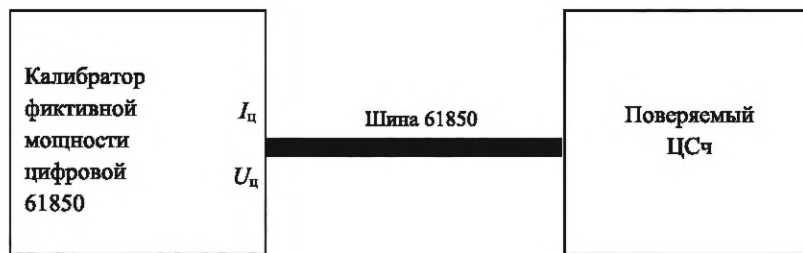
Рисунок А.2 — Схема однофазной испытательной цепи с применением калибратора электрической мощности (энергии) для испытания точности однофазного ЦСч
