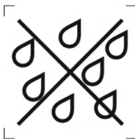
Рисунок 2 — Символ, наносимый на лампы, предназначенные для использования в сухих условиях или в светильнике, обеспечивающем защиту
