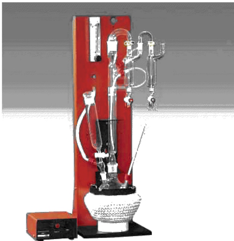
Рисунок А.2 — Установка для дистилляции сернистой кислоты \text{KSO}_2
