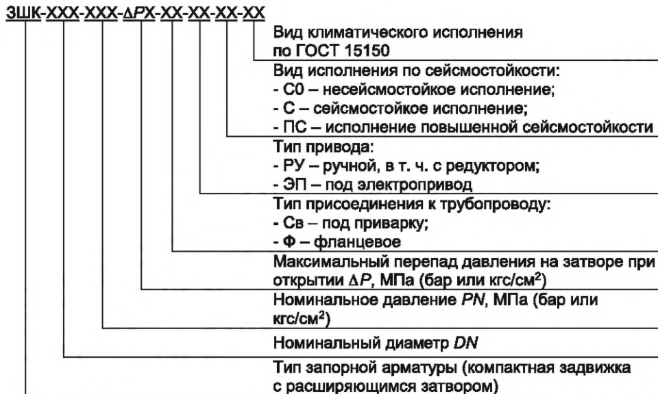
Рисунок 5.1 — Схема условного обозначения задвижки
