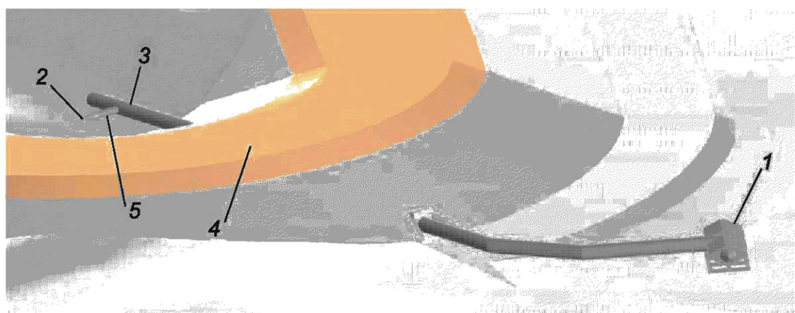
б) Размещение средства отбора ихтиопроб на отводном патрубке напорного трубопровода
