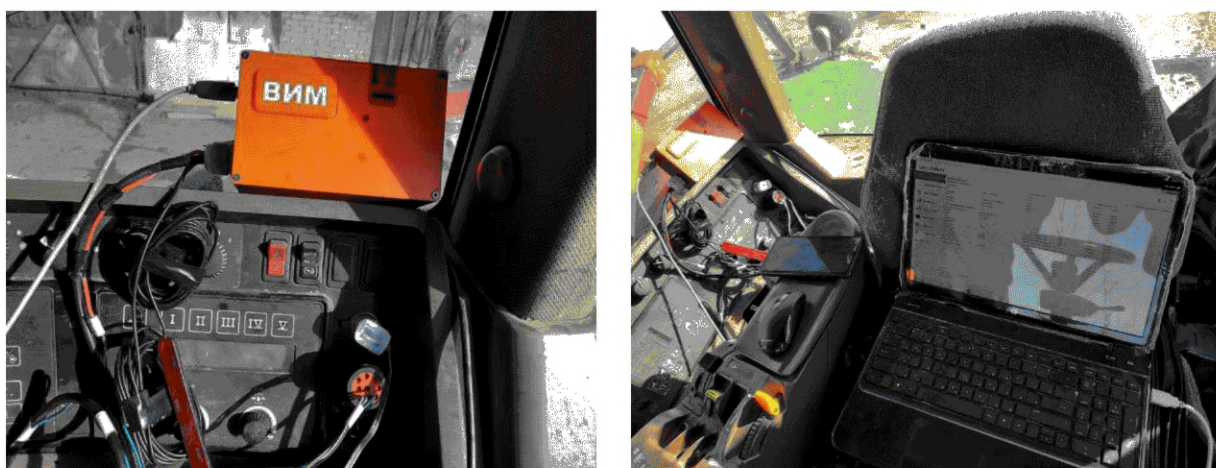
Рисунок Д.1 — Расположение диагностического прибора в кабине трактора
