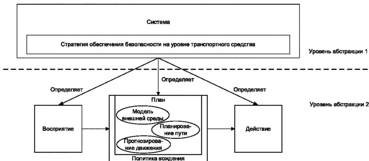
Рисунок D.1 — Пример упрощенной архитектуры транспортного средства, оборудованного ADS, с политикой вождения
