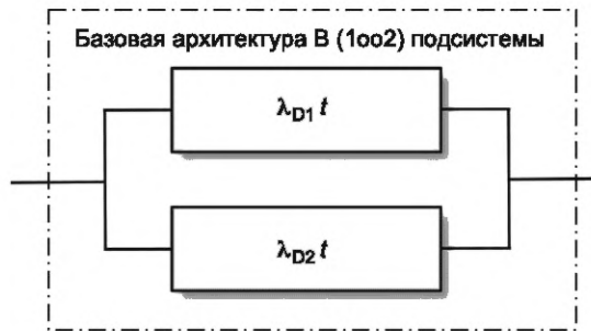
Рисунок H.12 — Блок-схема надежности базовой архитектуры В (1oo2) подсистемы
