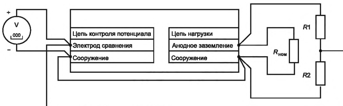
Рисунок 5 — Схема проверки стабилизации установленного значения потенциала с омической составляющей
