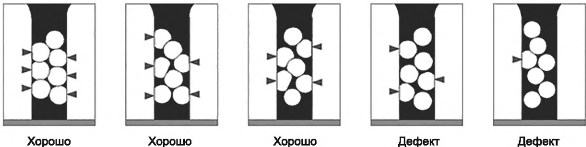
Рисунок В.6 — СПИ: поперечный микросрез
