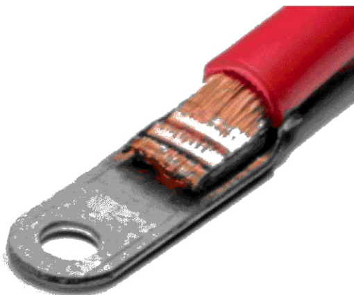
Рисунок 14 — Пример 3 ультразвуковой сварки на наконечнике
