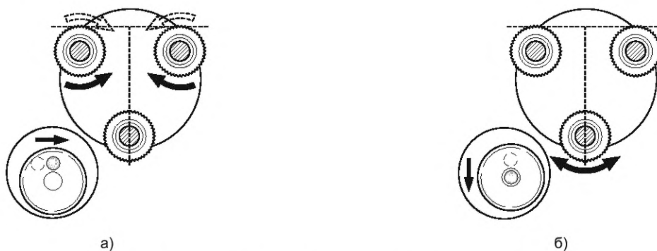
Рисунок 1 — Схема установки круглого уровня
