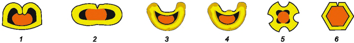
1 — В-обжим; 2 — овальный обжим; 3 — трапецевидный; 4 — двухконтурный; 5 — четырехточечный; 6 — гексагональный
