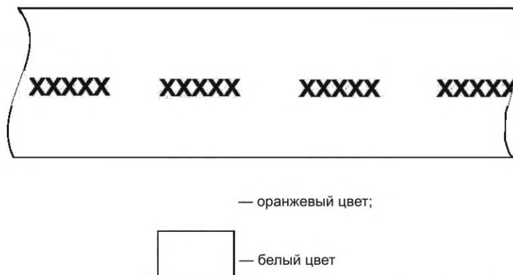
Рисунок 2 — Пример маркировки рукавов и гибких труб классов 1 и 2
