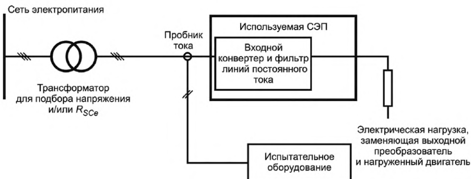
Рисунок В.7 — Испытательная установка с резистивной нагрузкой
