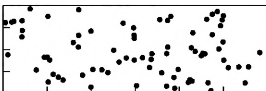
Рисунок А.7 — Процент пористости на поверхности: 5 %, 76 пор, d = 1 мм
