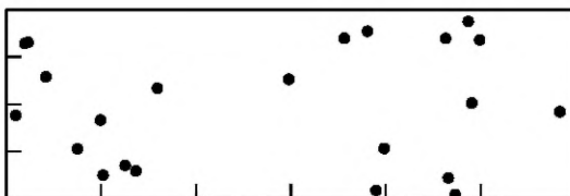
Рисунок А.2 — Процент пористости на поверхности: 1,5 %, 23 поры, d = 1 мм
