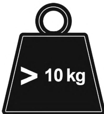
Рисунок 8 — Пример графического символа для деталей массой более 10 кг (применение ИСО 7000-1321В)
