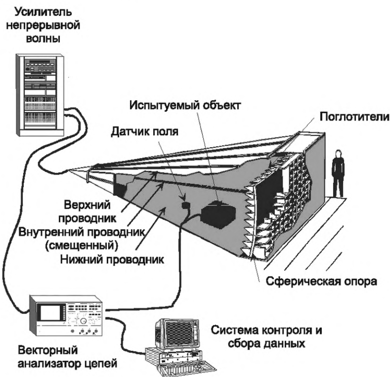
Рисунок 14 — Иллюстрация односторонней TEM-камеры и связанного с ней оборудования
