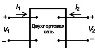
Рисунок D.1 — Соотношения напряжения и тока для общей двухпортовой сети
