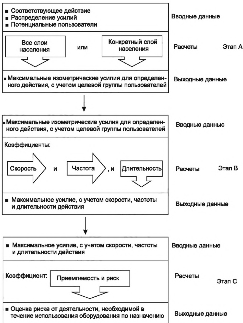
Рисунок 1 — Алгоритм оценки риска от усилий воздействия во время эксплуатации машин для стандартного контингента потенциальных пользователей
