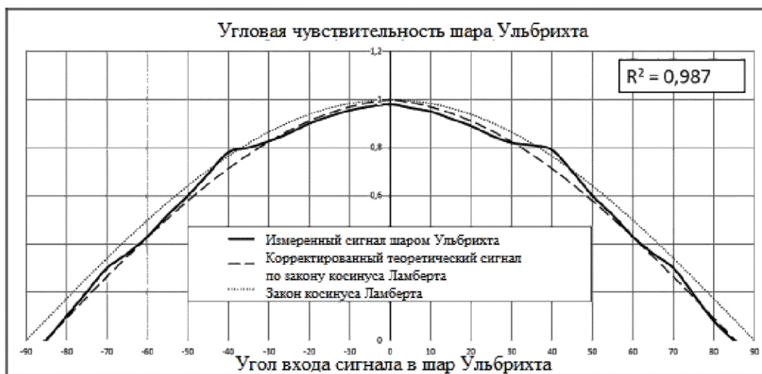
Рисунок J.3 — Результаты испытания на угловую чувствительность шара Ульбрихта (образец)
