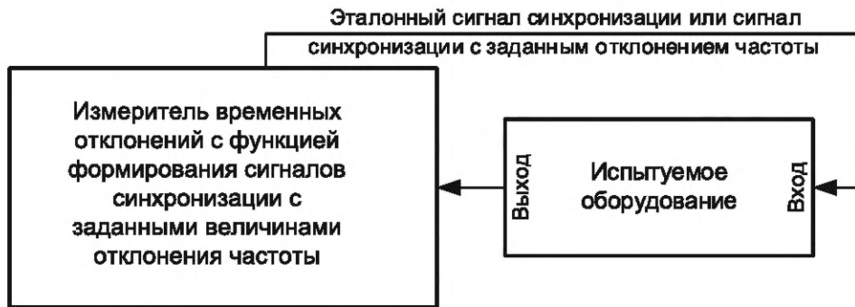
Рисунок И.5 — Схема испытательного стенда для измерения полосы захвата
