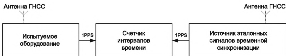
Рисунок И.10 — Схема испытательного стенда для измерения дрейфа фазы сигналов синхронизации и сигналов шкалы времени
