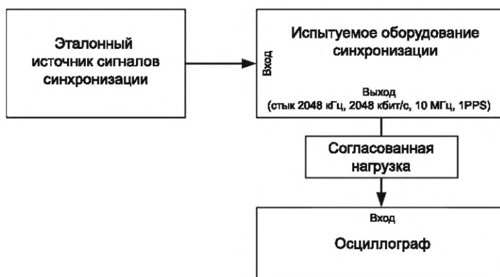
Рисунок И.2 — Схема испытательного стенда для проверки параметров выходных сигналов синхронизации
