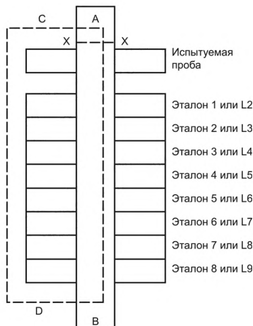
Рисунок 2 — Размещение испытуемых проб и синих шерстяных эталонов для воздействия по методу 1
