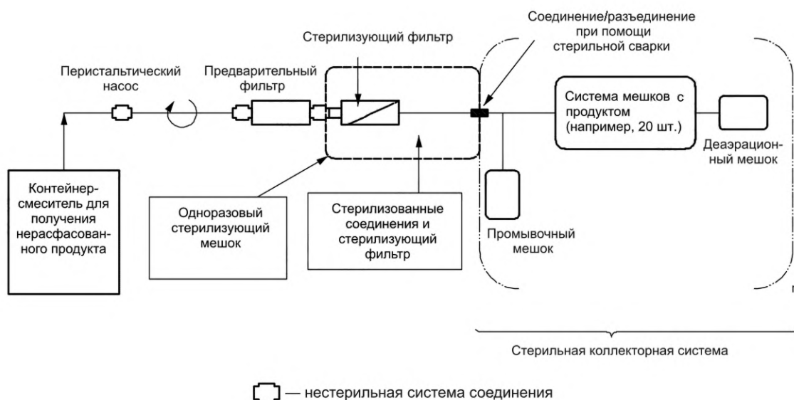
Рисунок F.1 — Общая схема системы наполнения с несколькими соединениями и разъединениями
