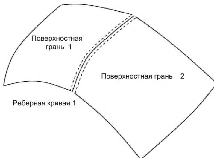
Рисунок 16 — Измерение зазора между параметрическими кривыми, связанными с ребром
