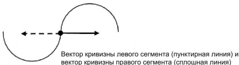
Рисунок 13 — Разрыв G2 вследствие разности направлений радиусов кривизны
