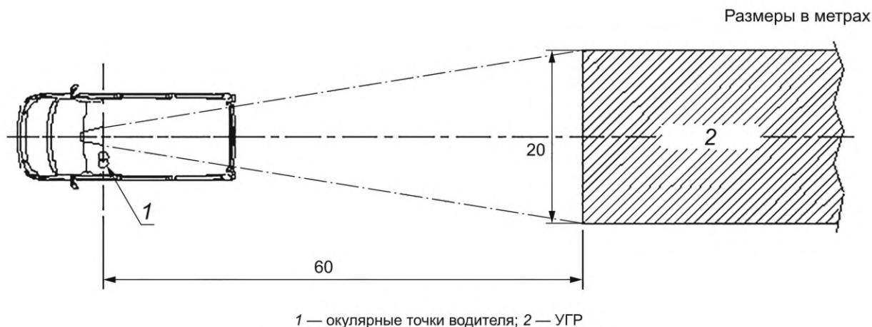
Рисунок 8 — Поле обзора устройства класса I
