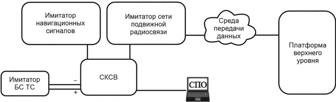
Рисунок Г.1 — Схема испытательного стенда
