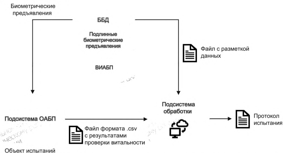
Рисунок 1 — Схема испытательного стенда для проведения технологических испытаний подсистем ОАБП
