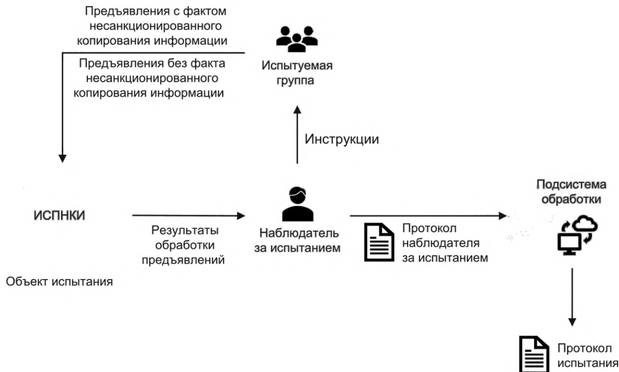
Рисунок 2 — Схема испытательного стенда для проведения сценарного испытания ИСПНКИ
