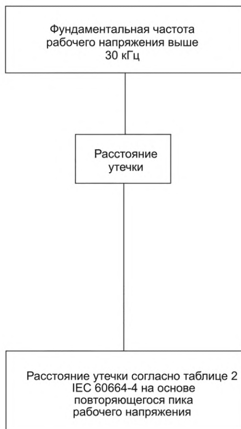
Рисунок Е.2 — Определение утечки для частот более 30 кГц
