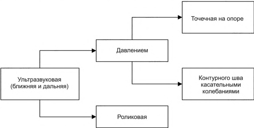
Рисунок Б.6 — Схема видов и групп сварки механического класса
