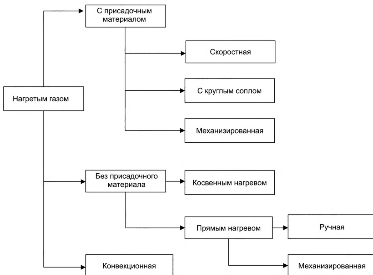
Рисунок Б.2 — Схема видов и групп сварки термомеханического класса
