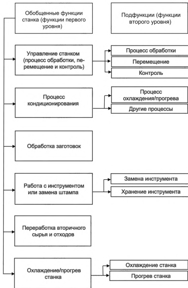
Рисунок 5 — Пример обобщенных функций и подфункций станка в отношении энергоэффективности (функции первого и второго уровня)
