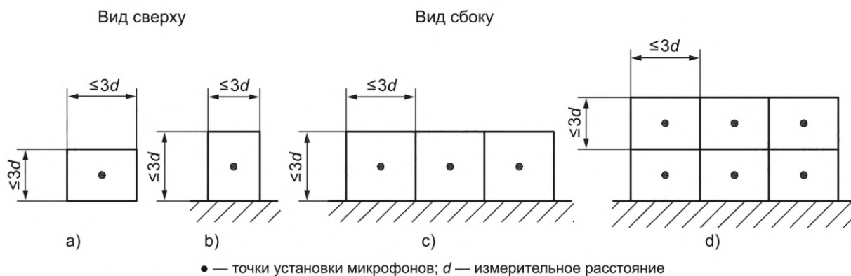
Рисунок С.1 — Точки установки микрофонов на измерительной поверхности в виде параллелепипеда
