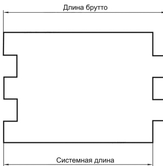
Рисунок А.1 — Размеры изделий с пазогребневым соединением
