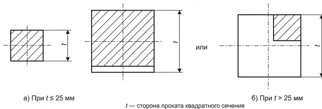
Рисунок В.2 — Схема отбора проб от проката квадратного сечения
