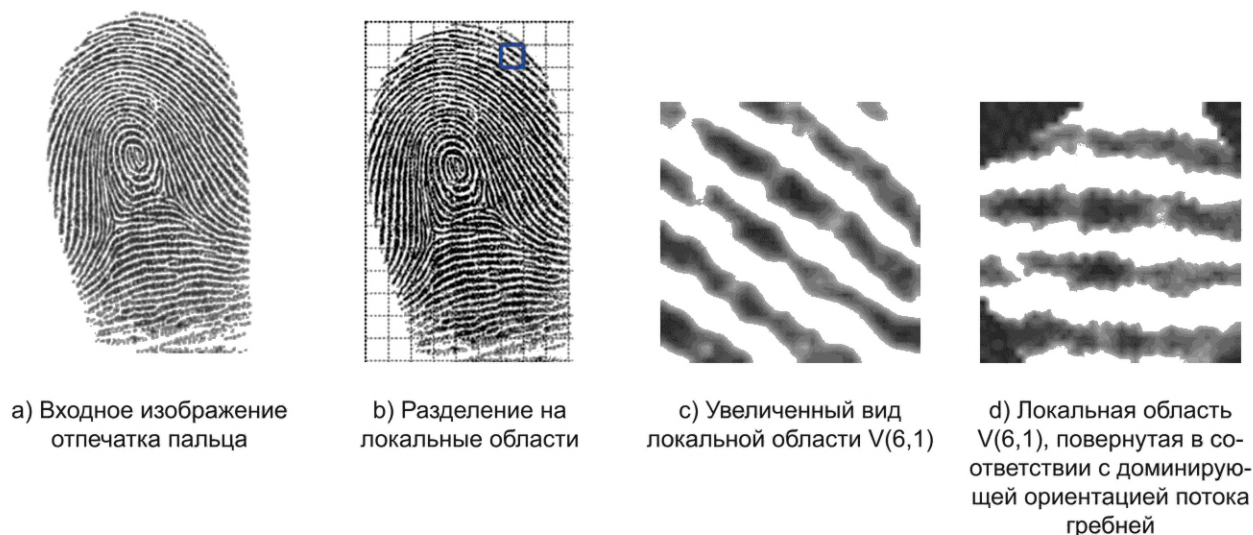
Рисунок 2 — Пример расчета доминирующей ориентации гребней для локальной области
