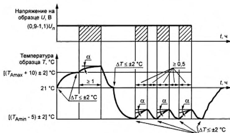
$T_{Amax}$  — заданная максимальная температура окружающей среды в эксплуатации;  $T_{Amin}$  — заданная минимальная температура окружающей среды в эксплуатации;  $U_n$  — номинальное напряжение;  $tg\alpha$  — градиент температуры;  $\Delta T$  — разность температур внутренней и внешней частей образца
