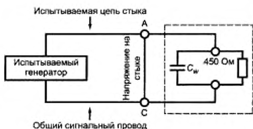
Рисунок 3 — Схема испытаний при генераторе, соответствующем рекомендации V.10, и различных значениях C_w
