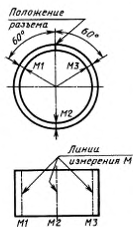
Рисунок 5 — Трехлинейная схема измерения для неразъемных или сварных втулок при D_0 \leq 150 мм
