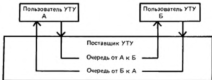
Рисунок 1 — Абстрактная модель соединения транспортного уровня
