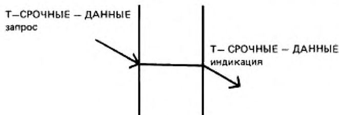
Рисунок 7 — Последовательность примитивов при успешной передаче срочных данных
