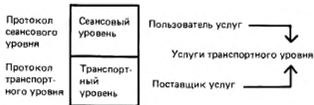
Рисунок В1 — Взаимоотношения услуг транспортного уровня с протоколами транспортного и сеансового уровней
