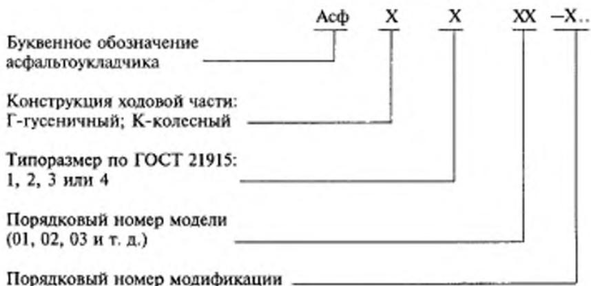
Пример индексации асфальтоукладчика гусеничного третьего типа-размера по ГОСТ 21915 четвертой модели второй модификации:
