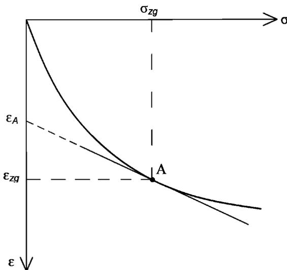
$\sigma$  — вертикальное напряжение, МПа;  $\epsilon$  — относительная деформация;  $\sigma_{zg}$  — природное вертикальное эффективное напряжение, МПа;  $\epsilon_A$  — условная величина относительной деформации, соответствующая точке пересечения касательной к компрессионной кривой в точке А с осью  $\epsilon$ ;  $\epsilon_{zg}$  — величина относительной деформации, соответствующая  $\sigma_{zg}$
