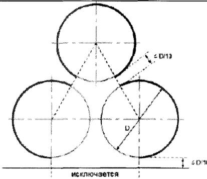
При горизонтальном расположении цилиндрических грузовых емкостей часть поверхности исключается, если расстояние между емкостями и между емкостями и опорной палубой составляет менее одной десятой диаметра  $D/10$
