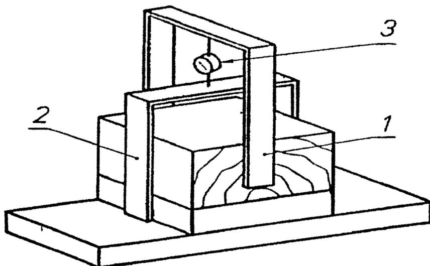
1 — скоба, зажимающая шашку; 2 — скоба, нажимающая на доску; 3 — прибор, измеряющий усилие, направленное на отрыв шашки от доски.
