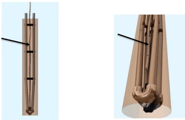
**Рисунок 9.3 – Активная термоскважина для ГТСТ (по центру – труба подачи воды для увлажнения грунта)**
